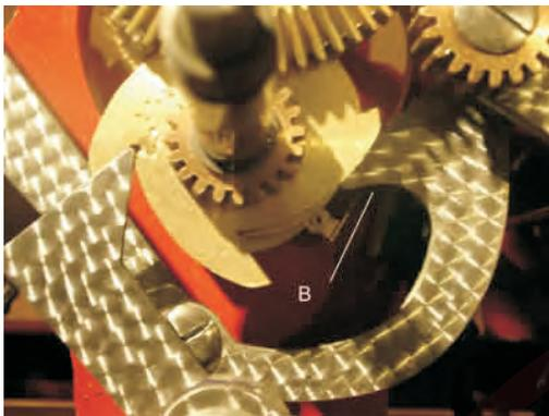
10.- Micro-interruptor de encendido del amplificador, la distancia de funcionamiento de este micro interruptor se ajusta por medio de los tornillos (Fig. 6)
